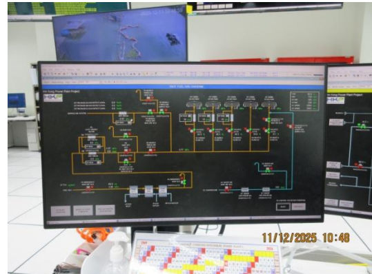
รูปที่ 3-7 ระบบ Dry Low NOx (DLN)
