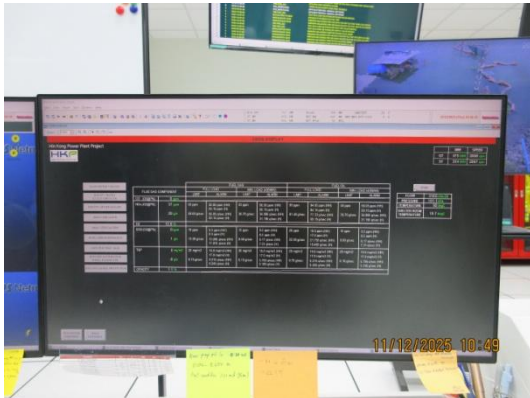
รูปที่ 3-6 การกำหนดค่าสัญญาณการแจ้งเตือน (Alarm) จากอุปกรณ์ CEMS
